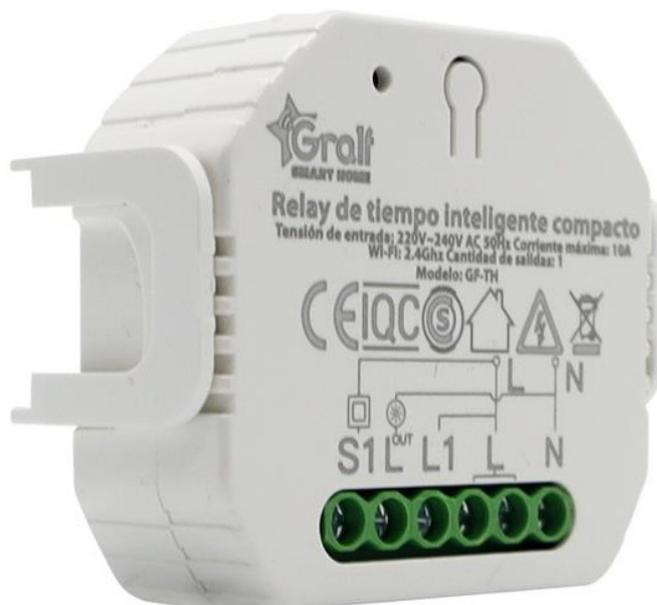
Este dispositivo actúa en forma de ON/OFF y puede ser conectado a la red eléctrica con una tensión de 220V. Es manejado a través de una aplicación mediante su dispositivo inteligente, con lo cual puede controlar luces, televisores, ventiladores, aires acondicionados, y todo aquel dispositivo que tenga un consumo menor a 10A. Ideal para montar sobre rieles din o en cajas de luces espaciosas.
