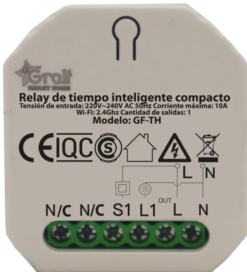
Este dispositivo actúa en forma de ON/OFF y puede ser conectado a la red eléctrica con una tensión de 220V. Es manejado a través de una aplicación mediante su dispositivo inteligente, con lo cual puede controlar luces, televisores, ventiladores, aires acondicionados, y todo aquel dispositivo que tenga un consumo menor a 10A. Ideal para montar sobre rieles din o en cajas de luces espaciosas.
