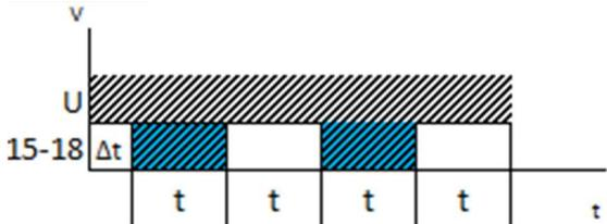
**Función E:** Actúa por pulsador entre terminales "S" y "A1". Flanco descendente, al soltar el pulsador funciona como un OFF Delay.
